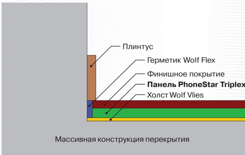
Укладка панелей PhoneStar в два слоя значительно улучшает звукоизоляционные свойства конструкции.
