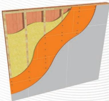
**Примечание:** для улучшения целевых свойств системы, пространство внутри каркаса из металлического профиля (деревянной обрешетки) дополнительно заполнить минеральной плитой или мягкой ДВП.
